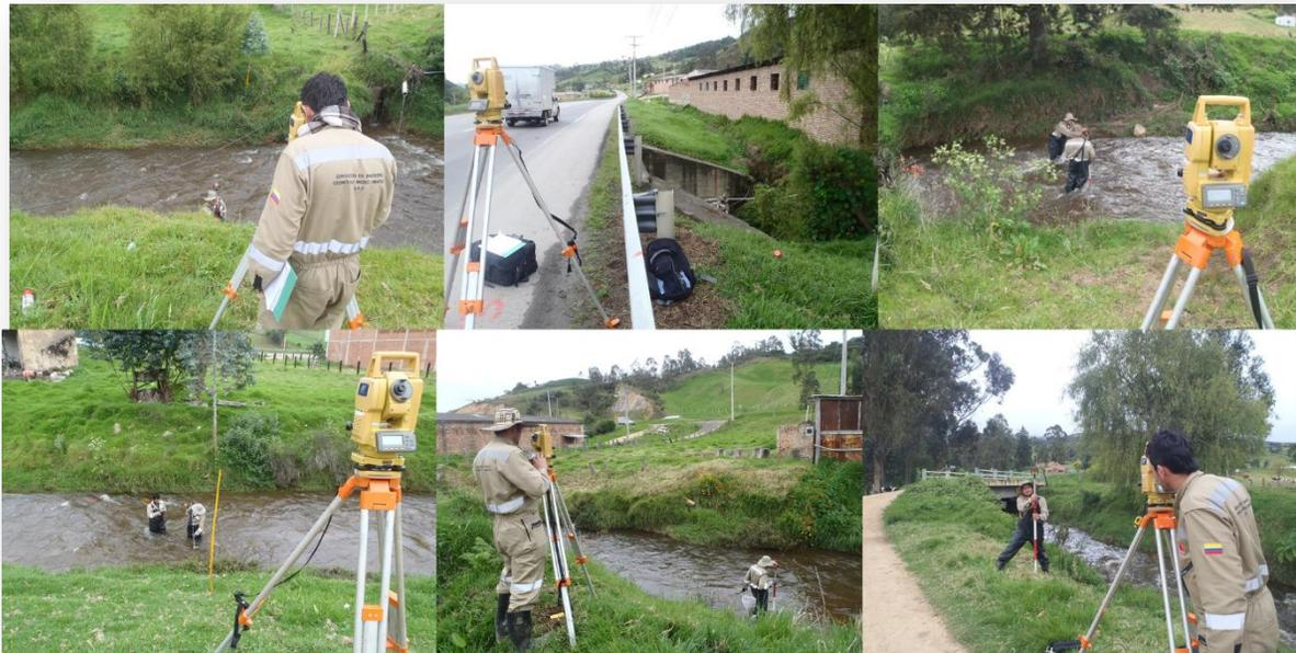
Figura 7. Procedimiento Levantamiento Topográfico-Batimétrico
